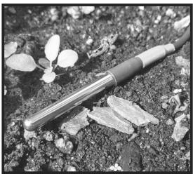
※センサーを土に埋める際は、直接土に挿さずに、スコップ等で掘って埋めてください。
