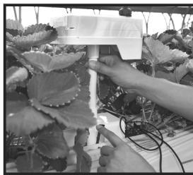
3 深さ15cm程度の穴を掘り地面と垂直に地中湿度センサーを埋めます。
