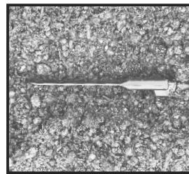
5 生長点温度センサーを取り付けます。
