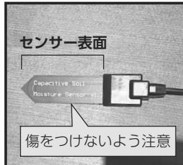
センサーが傷つくため、センサーで土を掘らないでください。
