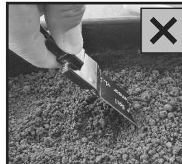
センサーが傷つくため、センサーを直接土に挿さないでください。
