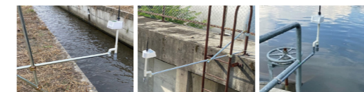
パイプを土手に打ち込み固定 ハシゴのパイプにクランプで固定 水門パイプにバンドで固定
