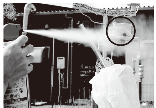
温度・湿度センサー部に袋を被せて丸で囲った雨量計にスプレーを噴射
